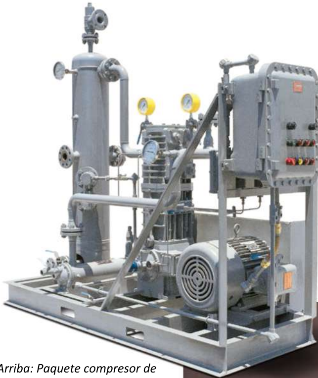
Sistema personalizado de compresor para GLP de una etapa 691-107B, diseñado para transferencia de gas licuado y recuperación de vapor
