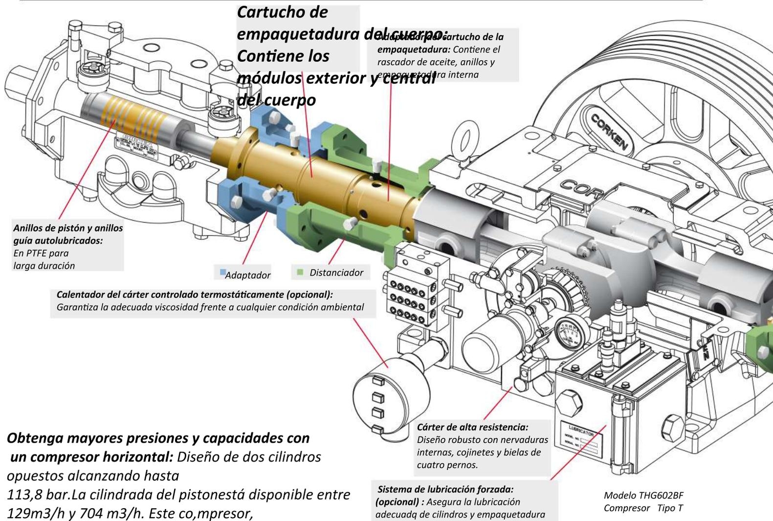
**Obtenga mayores presiones y capacidades con un compresor horizontal:** Diseño de dos cilindros opuestos alcanzando hasta 113,8 bar. La cilindrada del pistón está disponible entre 129m<sup>3</sup>/h y 704 m<sup>3</sup>/h. Este compresor, además de ser suave y silencioso, ofrece la flexibilidad de cambiar el tamaño de los cilindros según las necesidades y además se pueden configurar en una o dos etapas. Disponibles tanto en versión lubricada como sin aceite.
